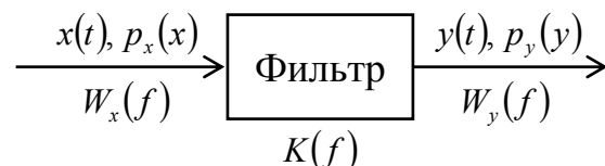
Рис. 2. Прохождение случайного процесса через линейную цепь.
