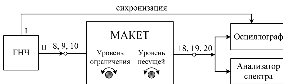
Рис. 4. Схема подключения приборов и измерительного стенда для наблюдения АМ сигналов.
