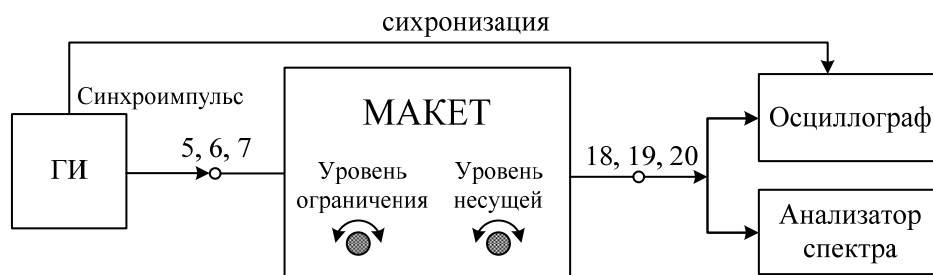
Рис. 5. Схема подключения приборов и измерительного стенда для наблюдения АМ сигналов.
