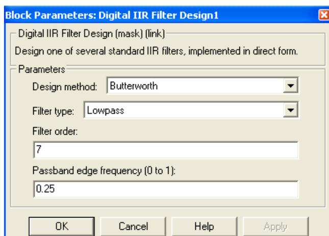
Рис. 7. Окно установки параметров фильтра
