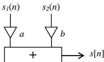
На рисунке слева изображён фрагмент схемы цифрового фильтра, отображающий алгебраическое суммирование двух сигналов.
