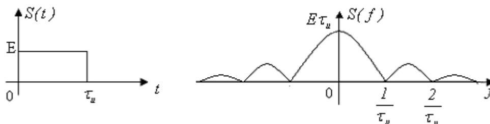
Рис.14.6. Прямоугольный импульс и модуль его спектра.
