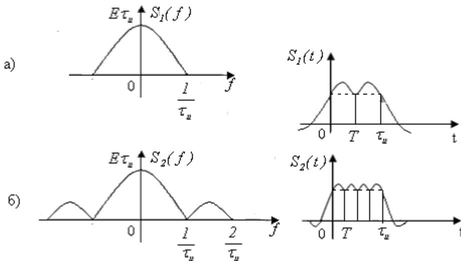
Рис. 14.7 Восстановление прямоугольного импульса при ограничении его спектра разными частотами
