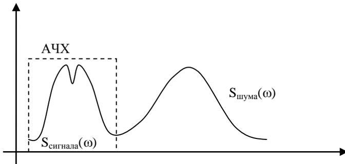
частотно-избирательного фильтра (ЧИФ), полоса пропускания которого совпадает с областью определения спектра сигнала. На рисунке 6.1. изображены спектры шума и сигнала, разнесенные по частоте и АЧХ идеального фильтра, подавляющего все частоты, не входящие в спектр сигнала. Форма АЧХ П-образная. Это позволяет сохранить форму спектра сигнала и полностью подавить помеху.
