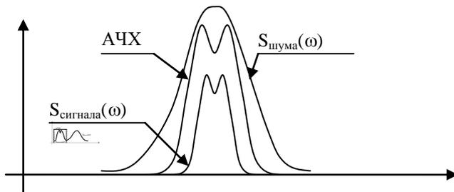
согласованного с сигналом. Форма АЧХ повторяет форму спектра сигнала и отличается от формы спектра шума. Это позволяет в конечном итоге максимизировать отношение сигнал/шум на выходе фильтра. Однако форма сигнала при прохождении через такой фильтр искажается. Поэтому такая фильтрация используется в задачах, когда информация заключена не в форме сигнала, а в самом факте его появления.
