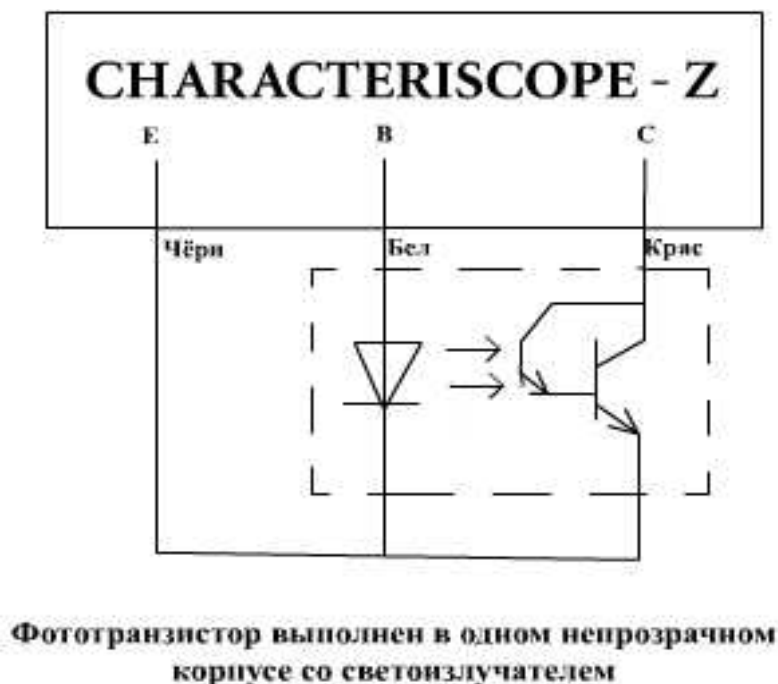
Рисунок 2. Схема подключения фототранзистора и светодиода к характеристоскопу.
